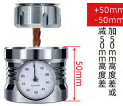
将 Z 轴设定仪置于工件上, 刀具接触测量面, 请慢速进刀使指针指在"0"则刀具与上把刀具距离同等, 与工件的高度差距离是 550mm
